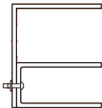
Guías de 1/4" de profundidad diseñadas a sujetarse directamente a la estructura del vano permitiendo un sellado perfecto
