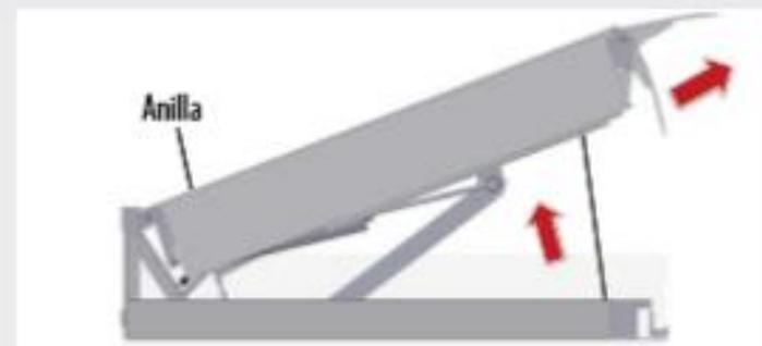
2. Tiramos de la anilla y mantenemos la tensión para liberar el freno y permitir que la rampa se eleve hasta la máxima posición y abra el labio.
