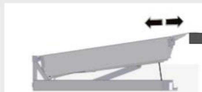
4. Una vez apoyada la rampa en el camión, este es el momento para iniciar el proceso de carga y/o descarga de mercancías con el tránsito de carretillas.
