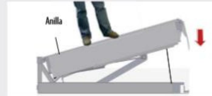
5. Una vez finalizado el proceso de carga y/o descarga, procederemos al cerrado de la rampa. Volvemos a tirar de la anilla hasta una altura media, sin llegar al máximo, y nos subimos de nuevo a la plataforma de la rampa para hacerla descender.
