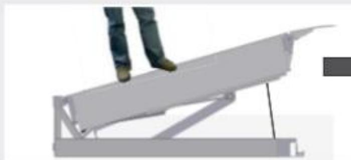
3. Una vez la rampa ha llegado a su máxima elevación, caminaremos encima de ésta para hacer descender suavemente la rampa y que ésta se apoye en la caja del camión.
